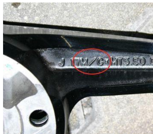
Bild 2: Reifen mit einer M/C-Kennzeichnung dürfen nur auf Motorradfelgen mit einem „M/C“ montiert werden.
