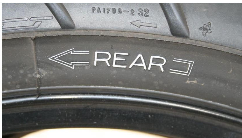
Bild 4: Vorgeschriebene Radposition und Drehrichtung des Reifens
