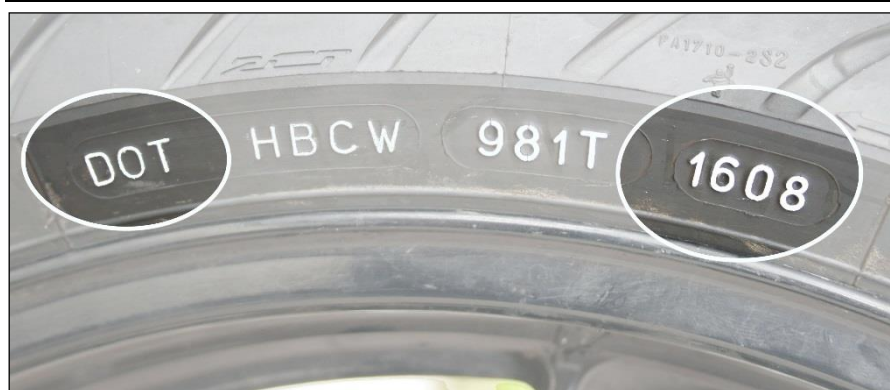
Bild 6: Die DOT-Nummer enthält viele verschlüsselte Daten, das Herstellungsdatum ergibt sich aus den letzten vier Stellen.
